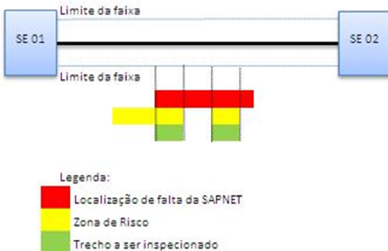
Figura 1 – Ilustração didática do critério de religamento especial de linhas
