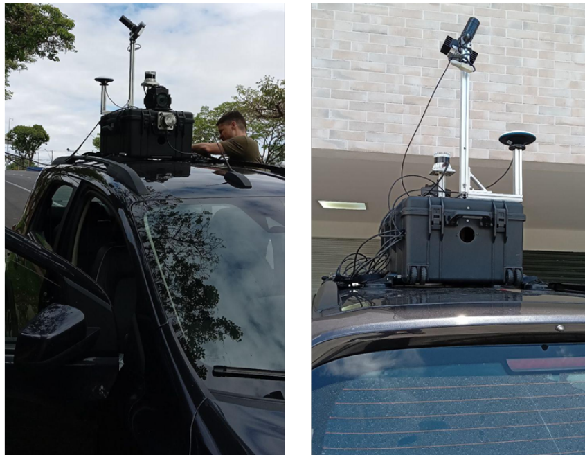
Figura 1- Configuração do sistema de captura instalado em veículo automotor
