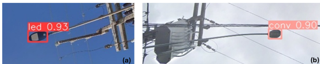
Figura 7 - Classificação entre lâmpadas de LED e convencional
