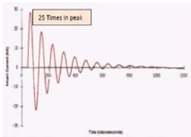
Figura 2 - Característica típica aceitavel da corrente de magnetização inrush
